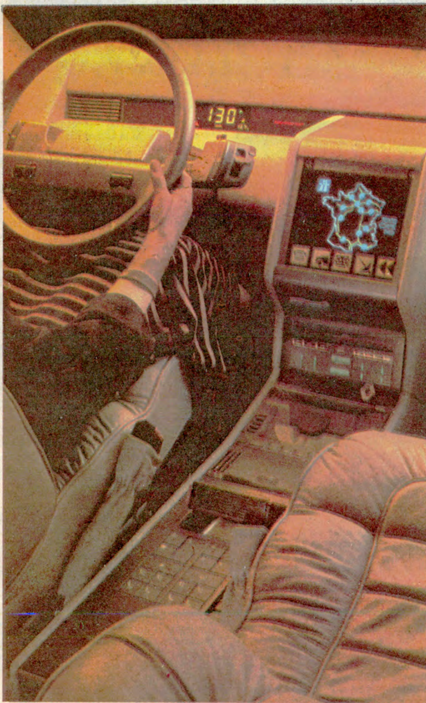
El sistema de navegación electrónica "Diálogo" con pantalla de visualización cartográfica de una ciudad, desarrollado por la empresa Renault de Francia.
